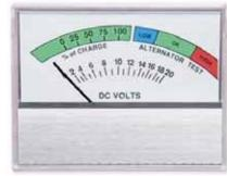
**Voltmeter / Test Meter**
